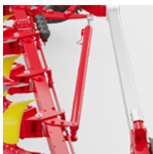
Гидравлическая настройка рабочей ширины
